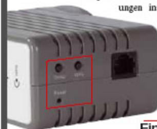
Alle Powerline-Adapter von Edimax verfügen über einen versenkten Reset-Taster und die „Group“-Taste. Mit letzteren lassen sich bestimmte Adapter zu unterschiedlichen logischen Netzen gruppieren, die voneinander unabhängig arbeiten.
